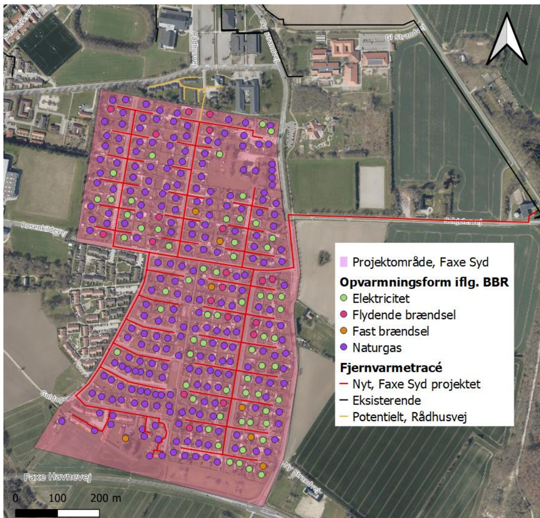
Figur 2. Hovedkilde til eksisterende opvarmning af ejendomme iht. BBR, område-afgrænsning, samt nyt fjernvarmetracé (projektet).
